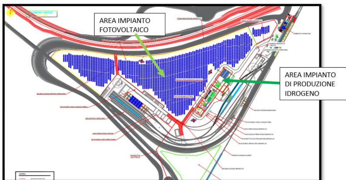
Figura 1. Planimetria area impianto di produzione idrogeno e impianto fotovoltaico
